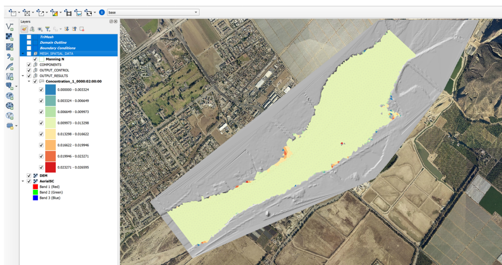
Figura 10.6 – Mapa de concentración de sedimentos en suspensión para el último paso de tiempo.
