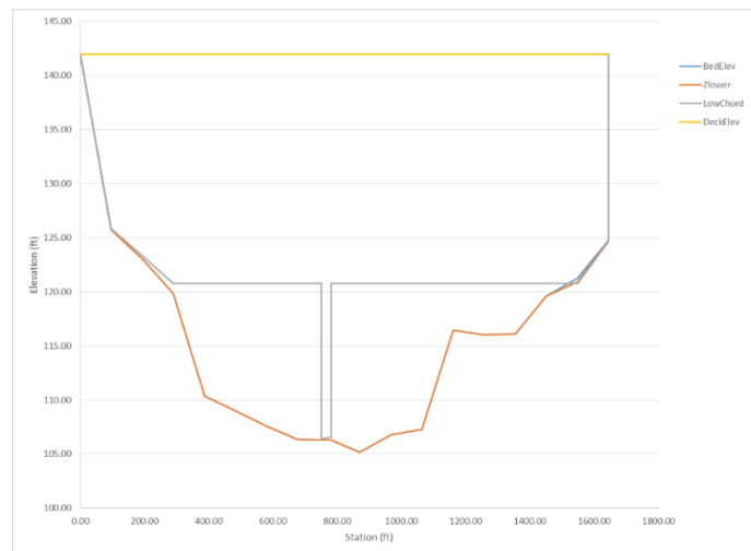
Figura 15.2 – Vista frontal de una sección transversal de puente.
