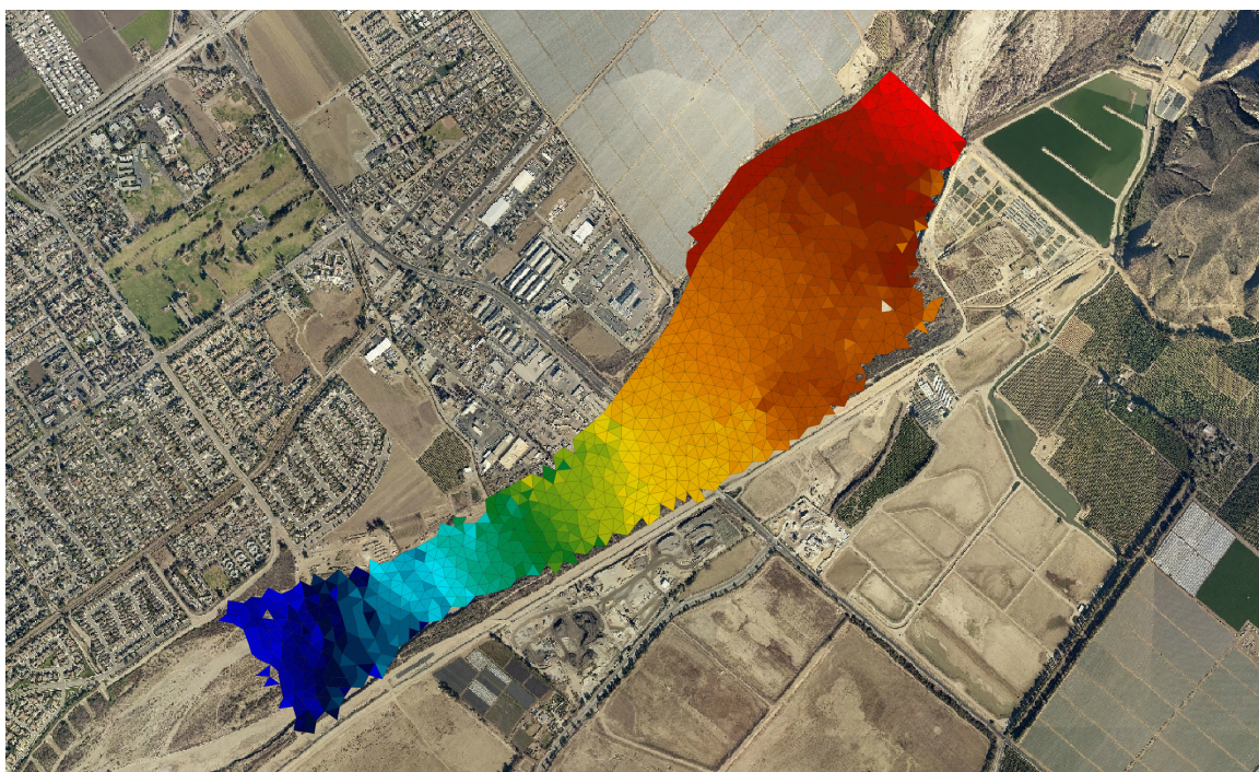
Figura 1.2 – Gráfico que muestra las elevaciones de la superficie del agua calculadas con RiverFlow2D.
