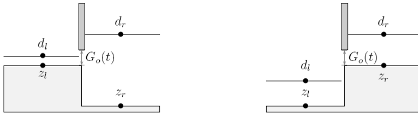
Figura 9.19 – Niveles de agua para descarga bajo compuerta en condiciones sumergidas formulados como en (G2).
