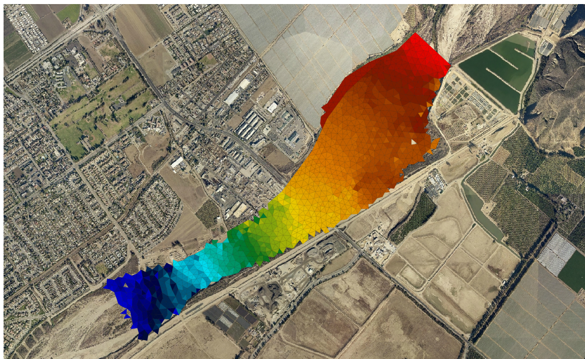
Figura 1.2 – Gráfico que muestra las elevaciones de la superficie del agua calculadas con HydroBID Flood.
