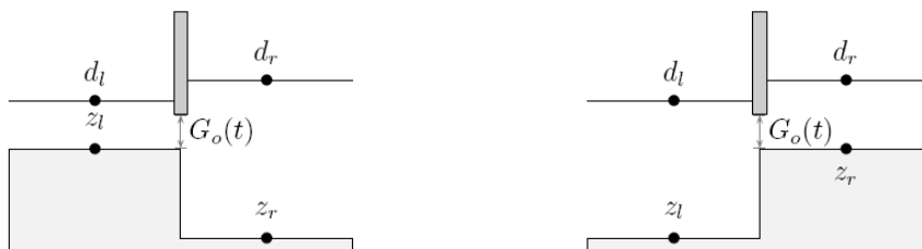
Figura 13.18 – Niveles de agua para descarga bajo compuerta en condiciones sumergidas formulados como en (G1).
