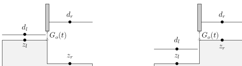
Figura 13.19 – Niveles de agua para descarga bajo compuerta en condiciones sumergidas formulados como en (G2).
